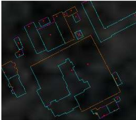
Abbildung 7.13: Probleme mit Gebäudegrundrissen: *cyan*: Linien, die direkt auf Flächendefinition folgen: aufgesammelt und verbunden; *orange*: Linien, die vorher definiert wurden; *rot*: Flächendefinitionspunkte; *violett*: Linien auf Hierarchie-Stufe 1; Bei zwei der gezeigten Flächen handelt es sich um Parkplätze.
