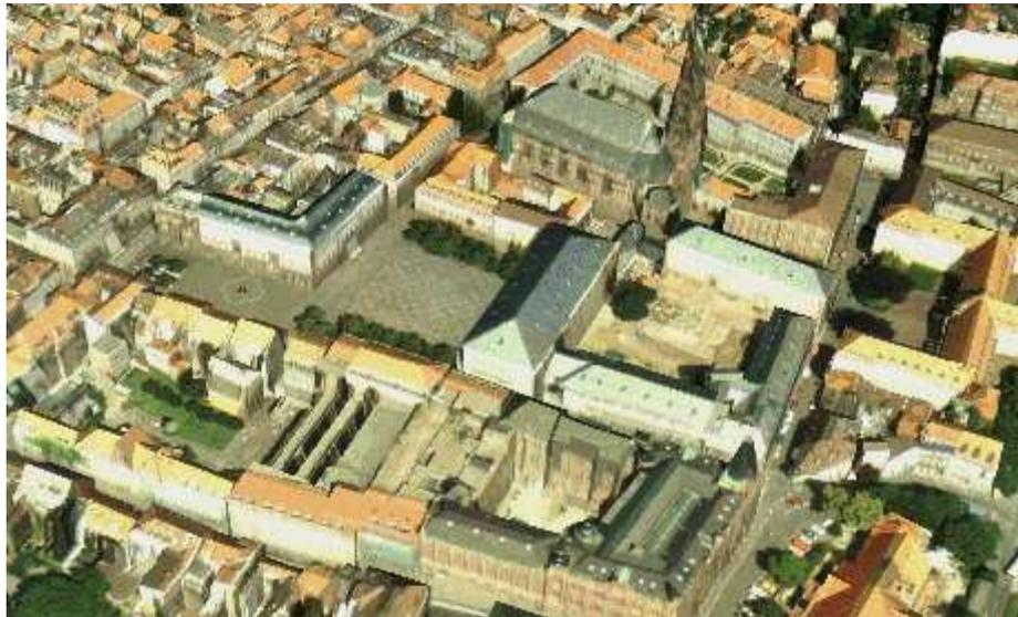
Abbildung 5.11: Heidelberg: Automatisch rekonstruierte Gebäude mit Luftfotos und teilweise manueller Fassadentexturierung (Quelle: [Bre00])
