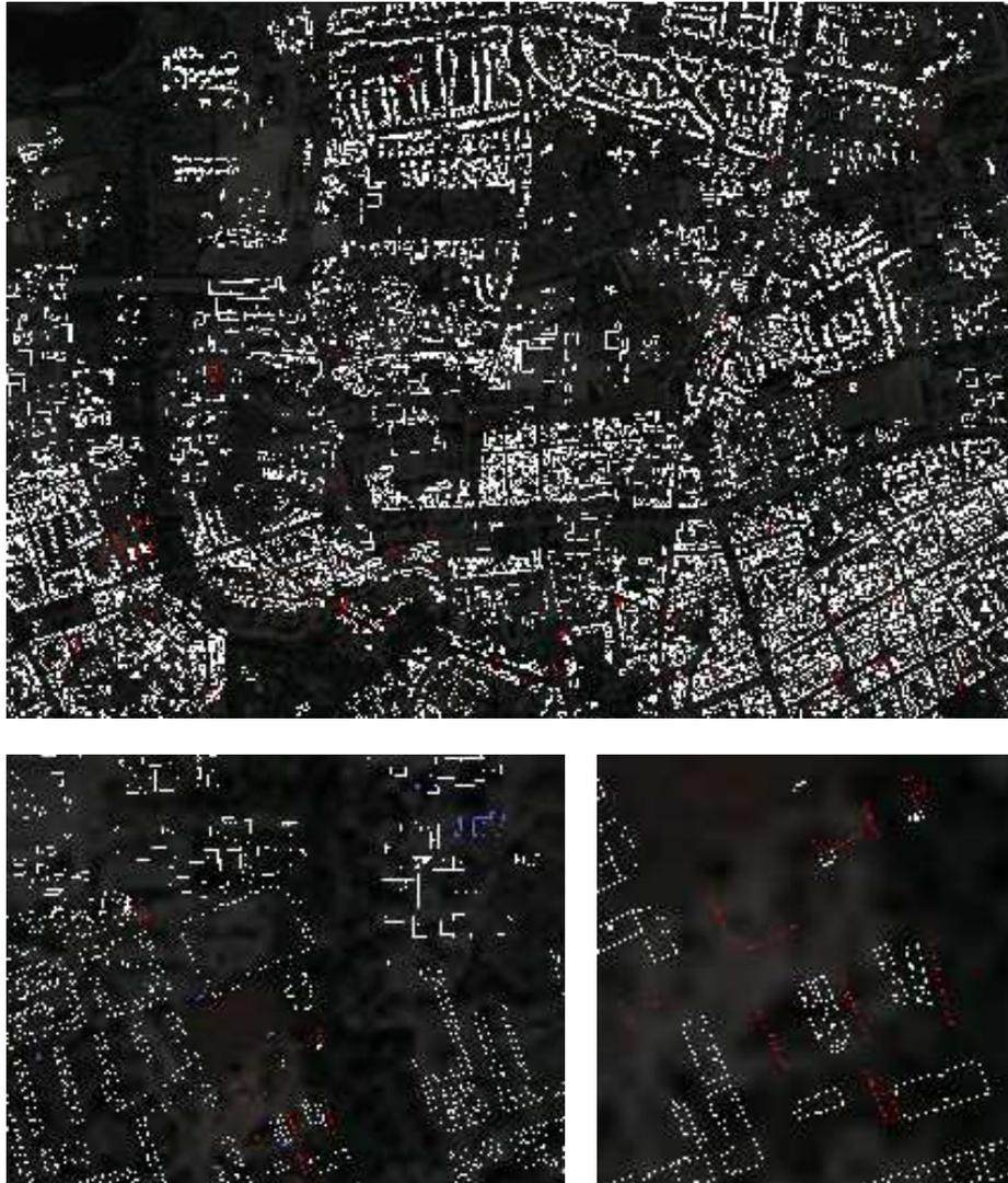
Abbildung 7.14: Probleme mit Gebäudegrundrissen: Übersicht und zwei Detailansichten: *weiß*: Fehlerlos erkannte Gebäude mit meist korrekten Grundrissen; *rot*: Gebäude ohne zusammenhängenden Grundriss; *blau*: Flächen ohne Schraffuren
